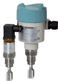
В качестве надежных сигнализаторов уровня жидких веществ прекрасно зарекомендовали себя вибрационные датчики уровня. Вилка датчика уровня вибрирует под пьезоэлектрическим воздействием на своей механической резонансной частоте, которая передается во встроенный блок электроники. Если вилочный зонд покрывает измеряемой средой, то колебание изменится. Затухание частоты, в свою очередь, будет уловлено электроникой, и сработает функция на выходе датчика уровня.
