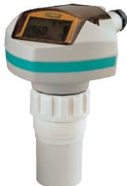
Уровнемер Sitrans Probe LU подходит для измерений уровня воды, сточных вод и химикатов. Диапазон измерения ультразвукового уровнемера Siemens Probe LU составляет 6 или 12 метров в зависимости от конфигурации. Функция автоматического подавления ложных отражений эхо-сигнала от неподвижных встроенных деталей, улучшенное отношение сигнал/шум и увеличенная точность в 0.15% от диапазона измерения обеспечивают высочайшую надежность и точность ультразвукового датчика уровня Probe LU.
